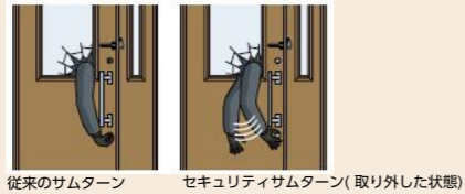
従来のサムターン セキュリティサムターン(取り外した状態)
