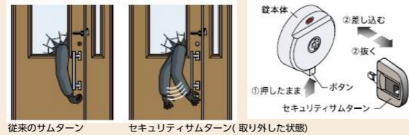
従来のサムターン セキュリティサムターン(取り外した状態)
